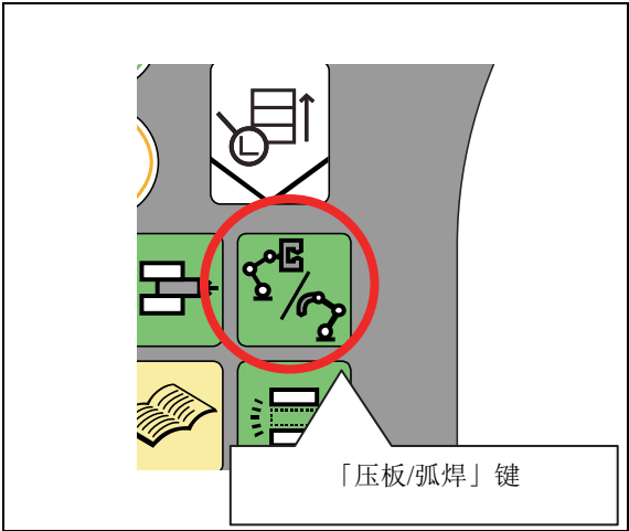
图 3.11.1 悬式示教作业操纵按钮台的「压板/弧焊」键
