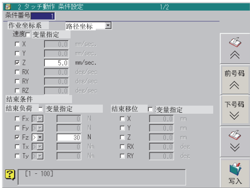
触碰动作 条件设定的示例（路径坐标系）
